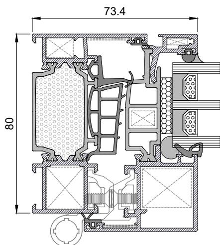
El sistema XP-80 CompaQ HI, de 80 mm de canal europeo, con RPT de 44 mm y un aislamiento térmico HI en cámara, ofrece las mejores prestaciones térmicas y acústicas.
