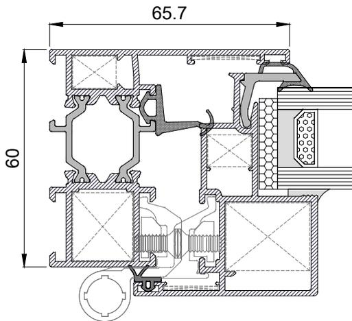
El sistema XP-60 HO de hoja oculta de 60 mm de canal europeo con el que se consigue mayor superficie de vidrio en la mínima sección constructiva.
