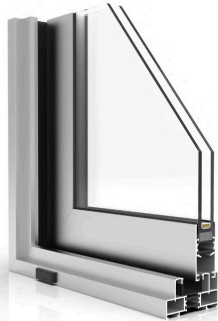
El sistema XS-60 ha sido diseñado para dar una solución minimalista y funcional en los proyectos de edificación. Su nudo central de solo 35 mm y su sección de 60 mm la convierten en una solución óptima tanto para obra nueva como para la rehabilitación de viviendas antiguas.
