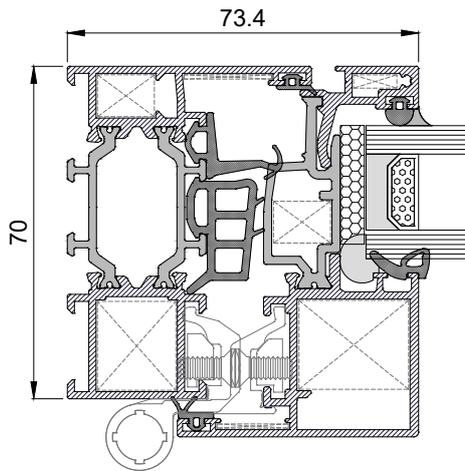
El sistema XP-70 Compaq, de 70 mm de canal europeo y con una RPT de 34 mm, garantiza un excelente comportamiento térmico y acústico. Diseñada para la arquitectura moderna, permite grandes ventanales sin sacrificar las prestaciones.
