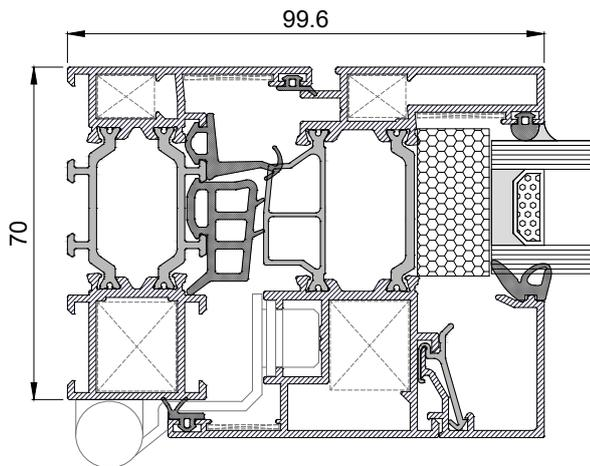
El sistema XP-70+, de 70 mm de canal 16 con RPT de 34 mm, permite un excelente comportamiento térmico y acústico. Está diseñada para la arquitectura moderna permitiendo grandes ventanales sin prescindir de prestaciones.
