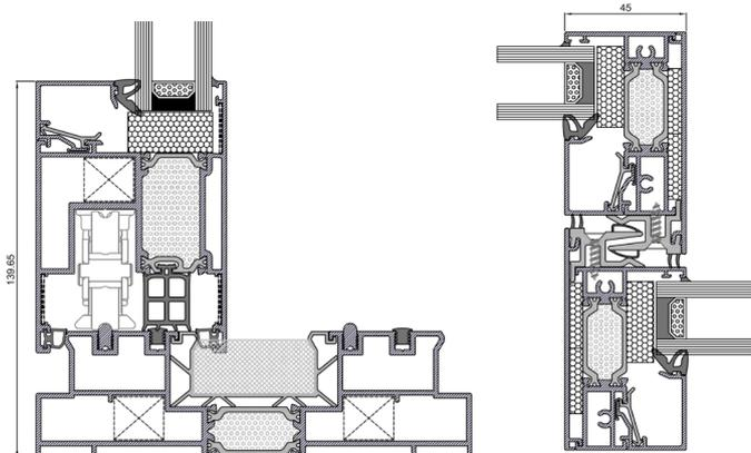
El sistema XS-160 HI ha sido diseñado para garantizar las máximas prestaciones en los ambientes más severos permitiendo triples acristalamientos. Este sistema cuenta con aislamiento térmico compacto de poro cerrado ocupando toda la cámara y nudo central minimalista de solo 45 mm.
