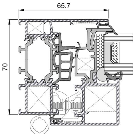
El sistema XP-70 HO, de 70 mm de canal europeo, puede usarse en todo tipo de proyectos manteniendo un diseño minimalista.
