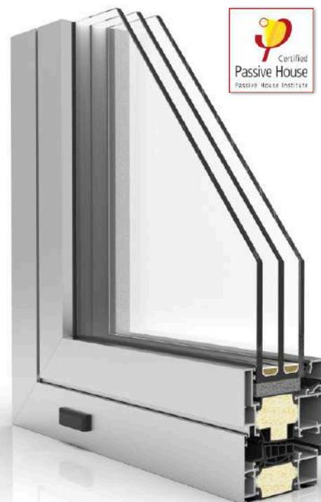
El sistema XP-80 HI, de 80 mm de canal europeo, con RPT de 44 mm y un aislamiento térmico HI en cámara, ofrece las mejores prestaciones térmicas y acústicas. Debido a sus propiedades, cuenta con la certificación PassivHaus.
